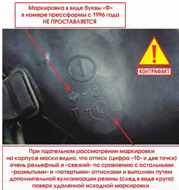
Рисунок 4.13. Пример контрафактной лицевой части противогаза ГП-7
