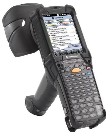
Рисунок 4.16. Считывающее устройство RFID-меток
