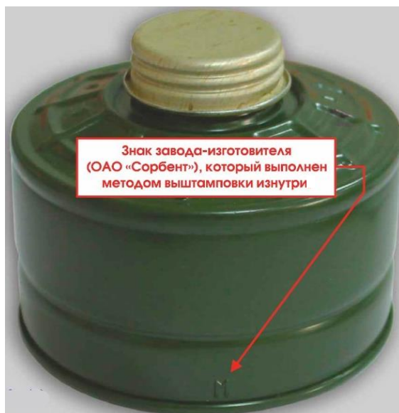
Рисунок 4.11. Дополнительный элемент антиконтрафактной маркировки ФПК ГП-7К
