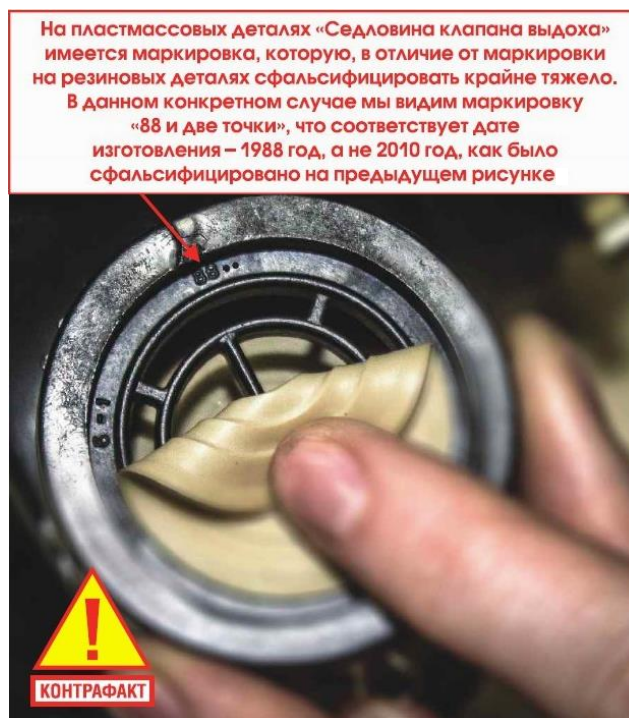
Рисунок 4.14. Пример контрафактной лицевой части противогаза ГП-7
