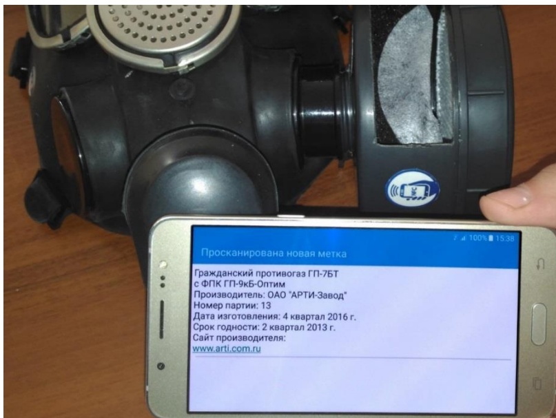
Рисунок 4.17. Считывание информации с чипа в ходе проведения исследований по выбору их оптимальных моделей
