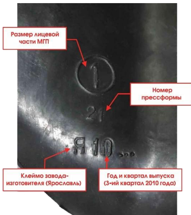
Рисунок 4.12. Маркировка оригинальной лицевой части МГП
